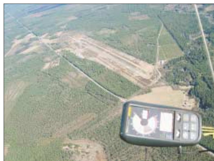
Variometri kertoo lennon korkeuden sekä nousu- tai laskunopeuden. Tässä kuvassa käynnissä on laskeutuminen. Vesa Lappalainen lentää 750 metrin korkeudessa. Nopeutta on 41 km/h ja lento laskeutuu kaksi metriä sekunnissa. KUVA: VESA LAPPALAINEN
