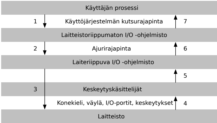
Kuva 0.31: I/O -operaatioon osallistuvat kerrokset, niiden väliset rajapinnat, ja operaation suoritusvaiheet ja osapuolet aikajärjestyksessä (1–7).
