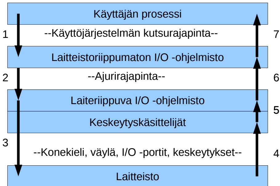
Kuva 21: I/O -operaatioon osallistuvat kerrokset, niiden väliset rajapinnat, ja operaation suoritusvaiheet ja osapuolet aikajärjestyksessä (1–7).
