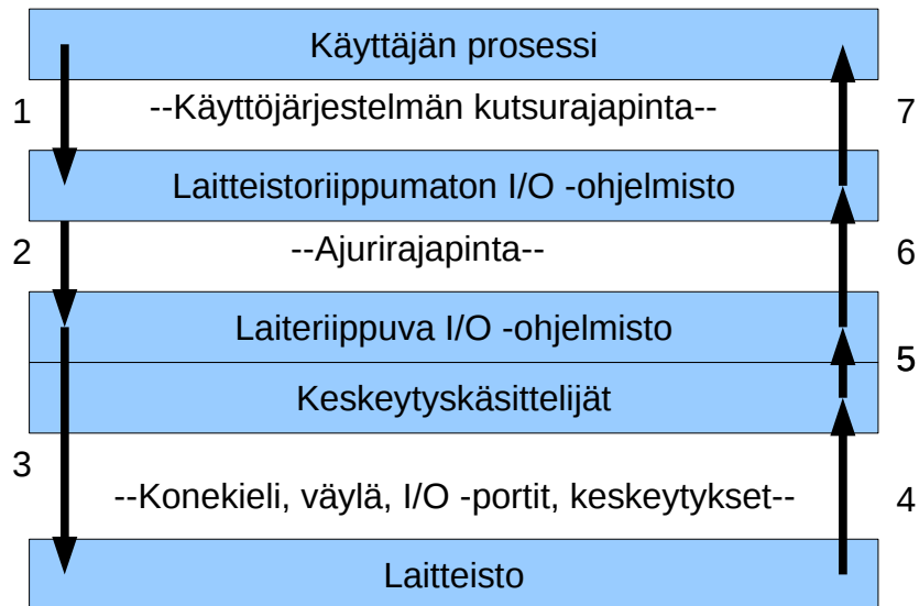
Kuva 20: I/O -operaatioon osallistuvat kerrokset, niiden väliset rajapinnat, ja operaation suoritusvaiheet ja osapuolet aikajärjestyksessä (1-7).
