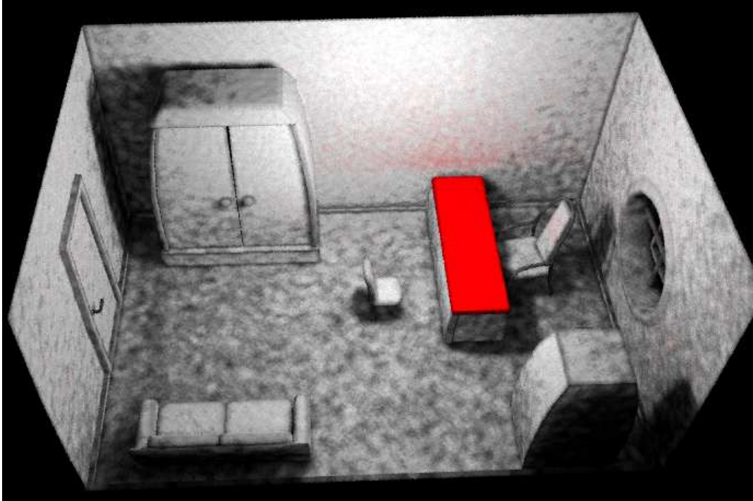
Kuva 4.3: Kun pinnan väri määritetään suoraan fotonikartan avulla, pinnalla esiintyy runsaasti matalataajuuksista kohinaa. Epäsuora valo ja värien vuotaminen voidaan silti havaita.
